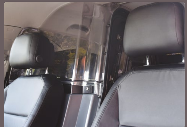
Cloison de séparation vue de face
